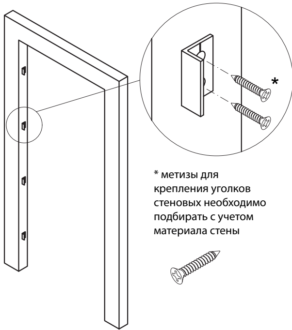
Схема расположения уголков стеновых в проёме
